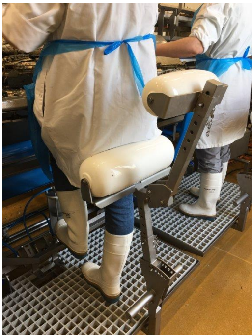
3. Siège "boudin" - réglable dans tous les sens grâce à un système hydraulique branché sur le réseau d'eau et avec une pédale réglable en hauteur.
