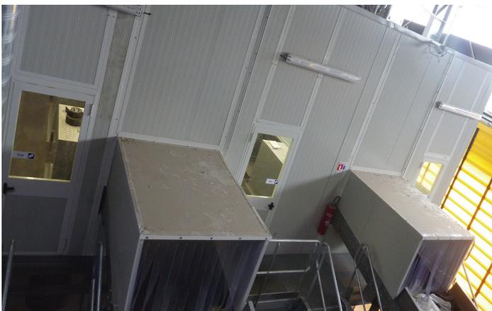
Cabine de tri avec plénum soufflant/tunnel acoustique/lumière extérieure
