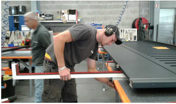
1. Mise en place du dispositif de guidage
