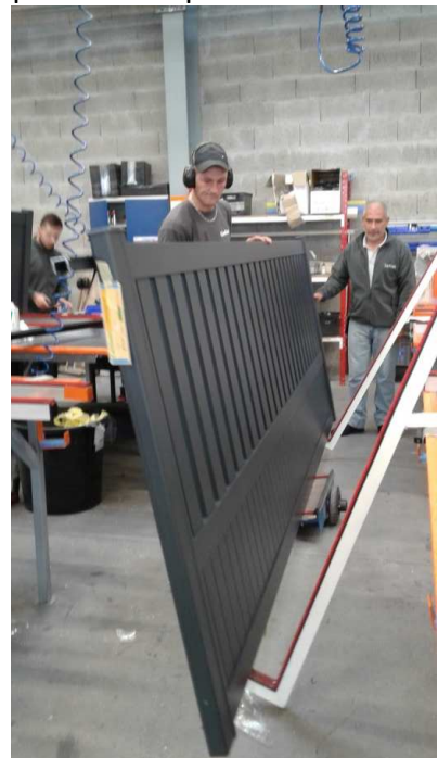
4. Récupération du portail sur chariot
