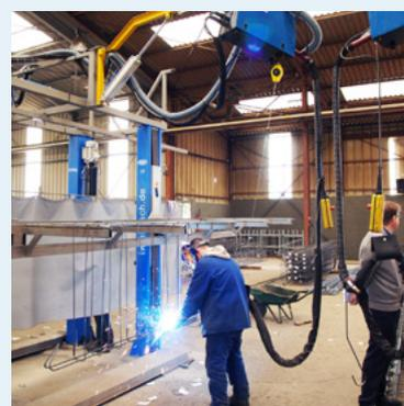
Potence articulée avec vérin de mise à hauteur des armatures
