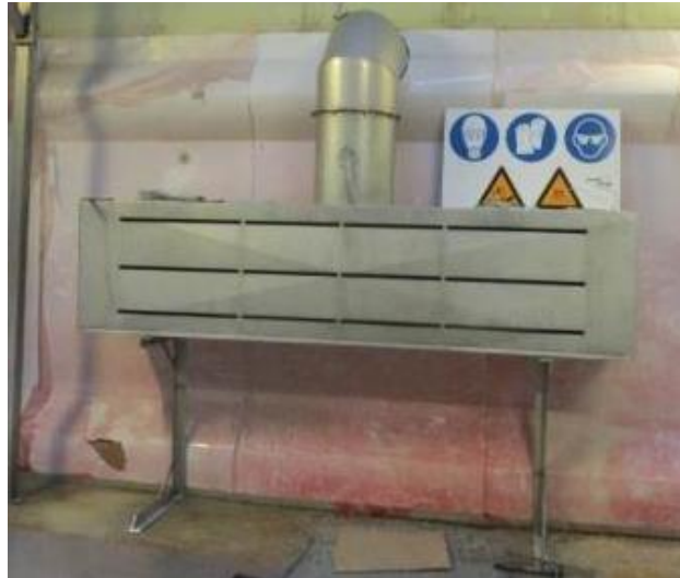
Caisson d'aspiration (3 m de large, 0,7 m de haut, 6300 m 3 /h)
