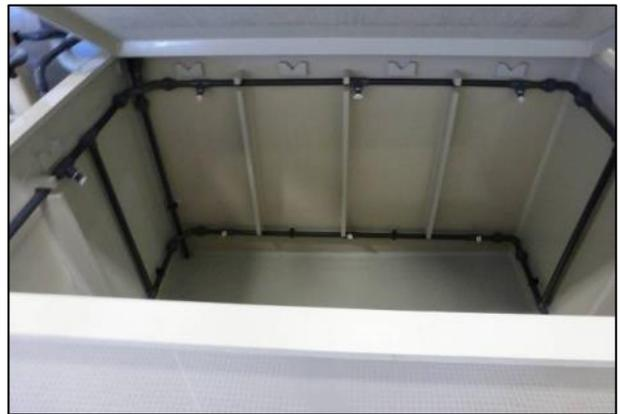
Cuve de traitement et rampes d'aspersion
