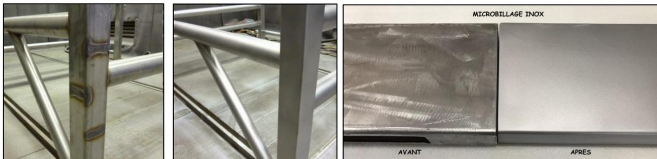
Exemple de nettoyage et décapage de soudure sur inox (Source : <http://www.aero-decap.fr/microbillage-inox>)
