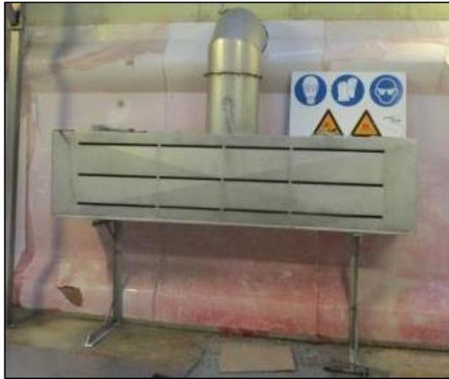
**Caisson d'aspiration (3 m de large, 0,7 m de haut, 6300 m<sup>3</sup>/h)
