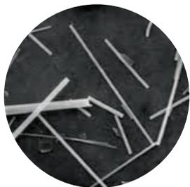
Ces fibres sont présentes dans les jupes chaudes, les plaques isolantes et les joints des chaudières.
