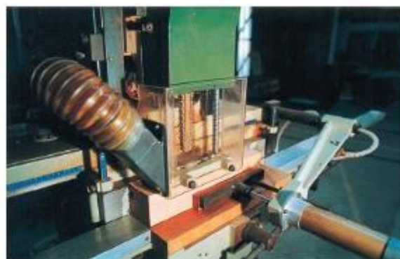
Photo du dispositif de captage implanté sur la machine.
