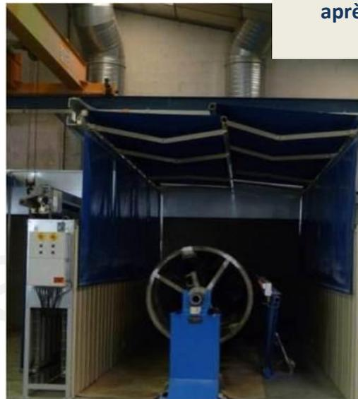
Confinement motorisé pour séchage après enroulement filamentaire (aspiration vers le fond)
