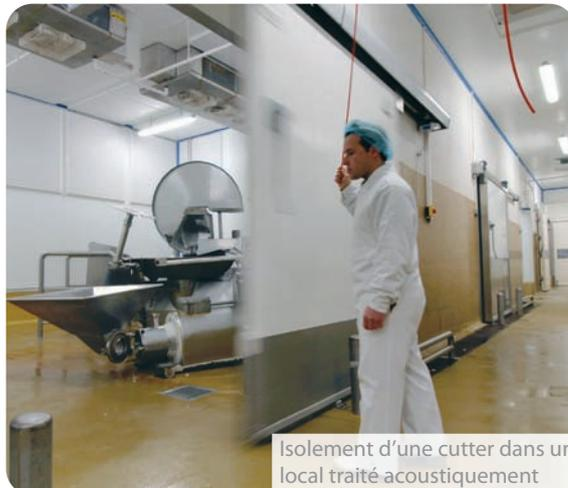
Isolément d'une cutter dans un local traité acoustiquement
