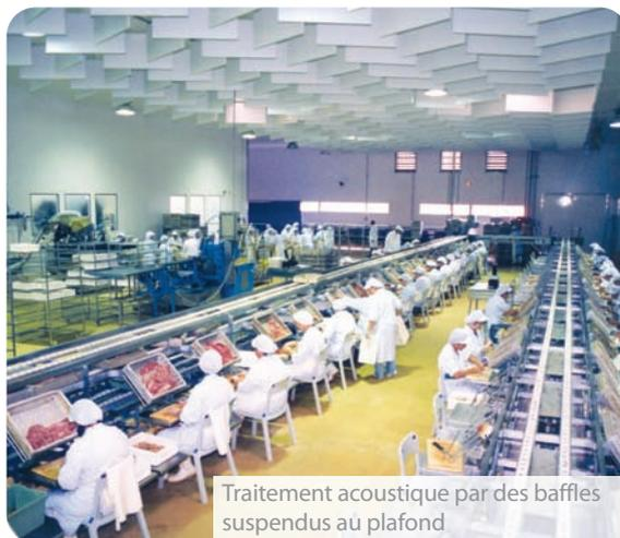
Traitement acoustique par des baffles suspendus au plafond
